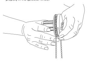
g) Shut sprocket cage.
